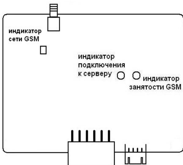
**На верхнюю крышку прибора выведены два светодиода:**
